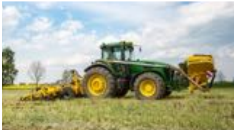
STRIP – MASTER EN + čelní zásobník na hnojivo FERTI BOX FB_F
