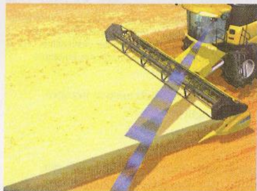
Abb. 10: Ein Laser am Mähdrescher tastet die Bestandeskante ab und die Informationen werden in Lenkimpulse umgewandelt (Werkbild CNH)
